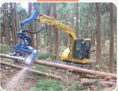
高性能林業機械による間伐
